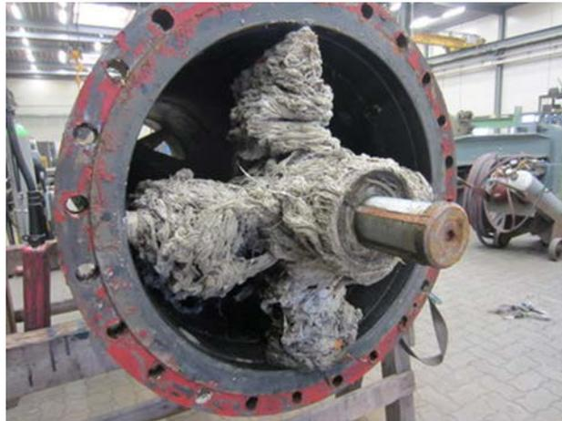
Feste Abfälle können sich bereits in den Rohrleitungen der Hausinstallation abgelagern. Die Folge sind Verstopfungen, die sich nur mit großem Aufwand beseitigen lassen. Speisereste im Kanal begünstigen die Vermehrung von Ratten.
