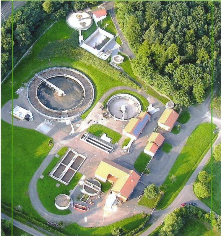
1. Das Abwasser aus Steinau Innenstadt und Seidenroth wird aus 9,0 Meter Tiefe auf Erdniveau hochgepumpt. Die Ortsteile Marborn, Ulmbach und Sarrod fließen der Anlage im freien Gefälle zu. Die Abwassermengen werden über MID (Magnetischer-Impuls-Durchlaufmesser) aufgezeichnet.
